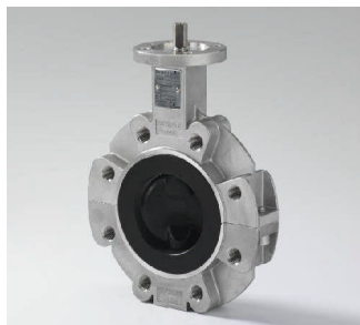
Lug 1.4408 (CF-8M) PTFE-AS/PFA-AS, bare shaft
